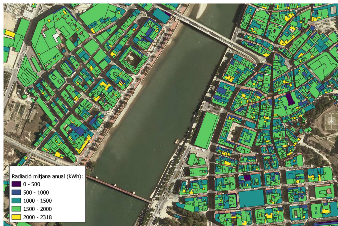
Figura 5. Retall sobre ortofotomapa al nucli urbà de Tortosa de la capa resultant del creuament de la capa cadastral i de la capa de radiació solar.
